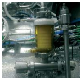
Decontamination of exhaust air with sterile filter / Decontaminazione dell'aria di scarico con filtro sterile
